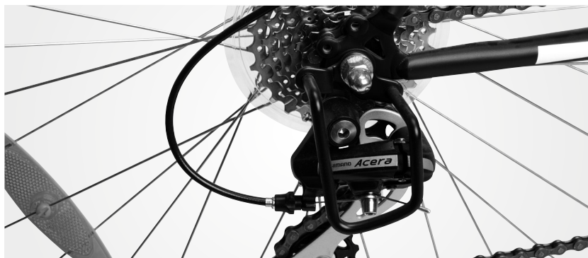
Växelskydd monterat på externa växlar
