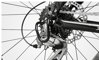
Växelskydd monterat med en bult
