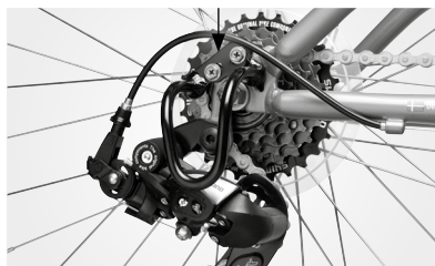
Växelskydd monterat med en bult
