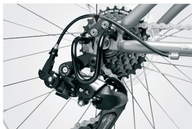
Gearbeskytter monteret vha. én bolt
