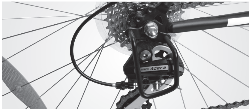
Gearbeskytter monteret på udvendige gear
