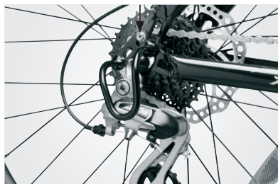
Gearbeskytter monteret vha. én bolt
