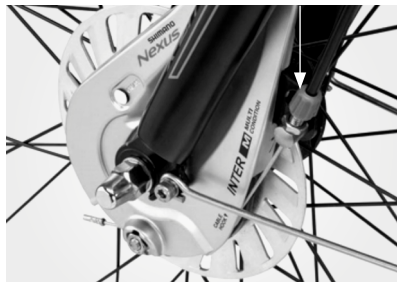
Justera bromsjusteringskruven fram
