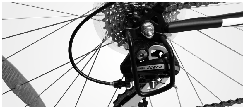
Växelskydd monterat på externa växlar
