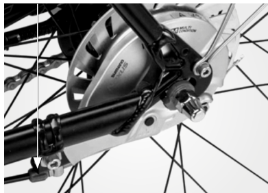
Justera bromsjusteringskruven bak
