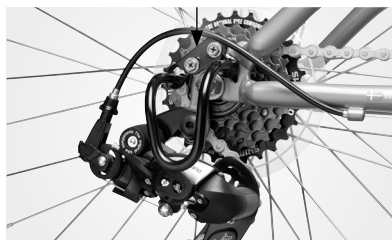
Växelskydd monterat med en bult
