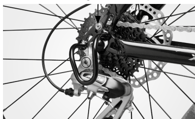
Växelskydd monterat med en bult
