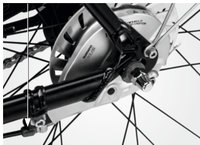
Justerskrue for justering af bremse bag
