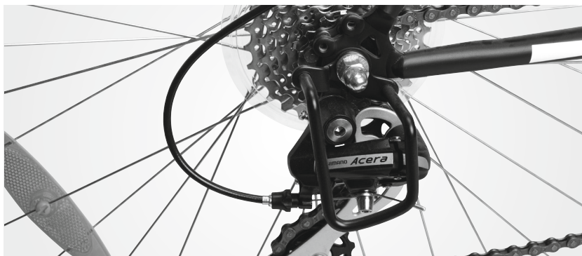
Gearbeskytter monteret på udvendige gear
