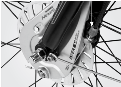
Justerskrue for justering af bremse for
