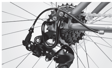
Gearbeskytter monteret vha. én bolt
