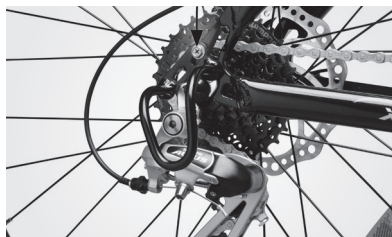
Gearbeskytter monteret vha. én bolt
