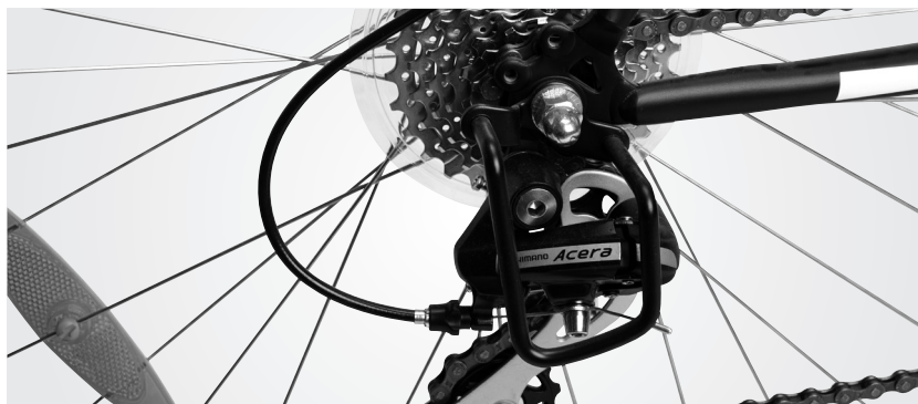
Gearbeskytter monteret på udvendige gear
