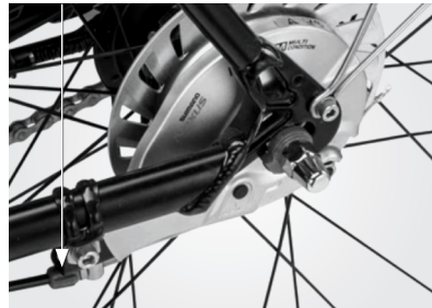
Justerskrue for justering af bremse bag
