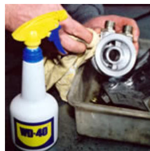
Fjerner gamle olie- og fedtresten før montagen.
