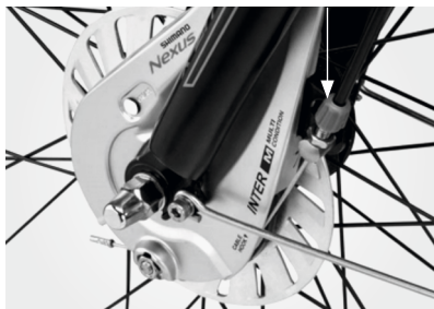
Justerskrue for justering af bremse for
