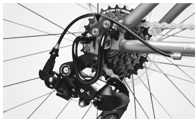
Gearbeskytter monteret vha. én bolt
