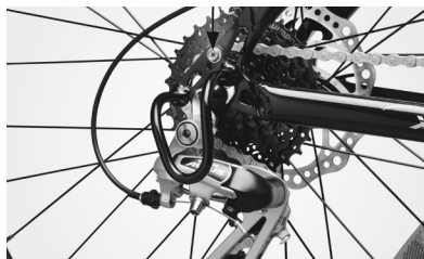
Gearbeskytter monteret vha. én bolt
